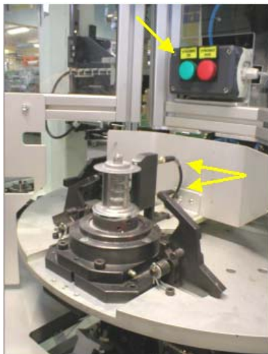
Obr. 2 Čidla pro detekci kompletnosti cívky a světelná signalizace OK / NOK dílu
