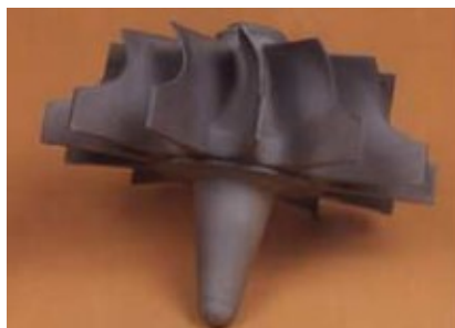
Obr. 11 Rotor turbíny gelovým litím
