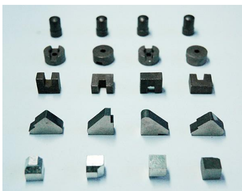
Obr. 8.49 Příklady použití magnetů AlNiCo [18].
