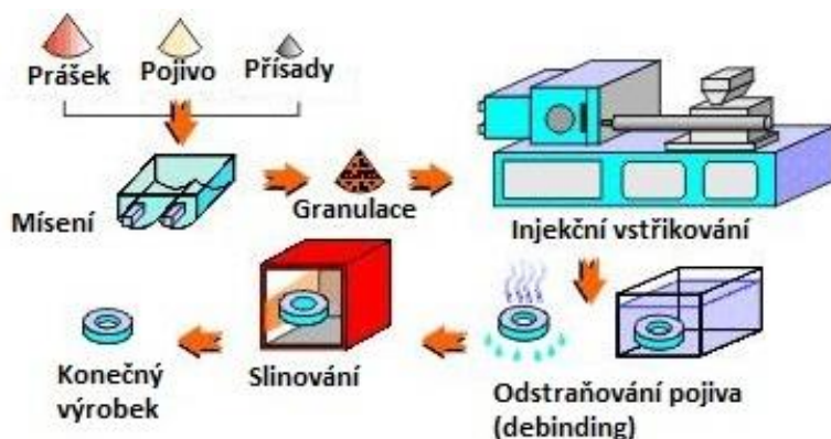
Obr. 6.26 Jednotlivé fáze technologie injekčního vstřikování kovů [14].
