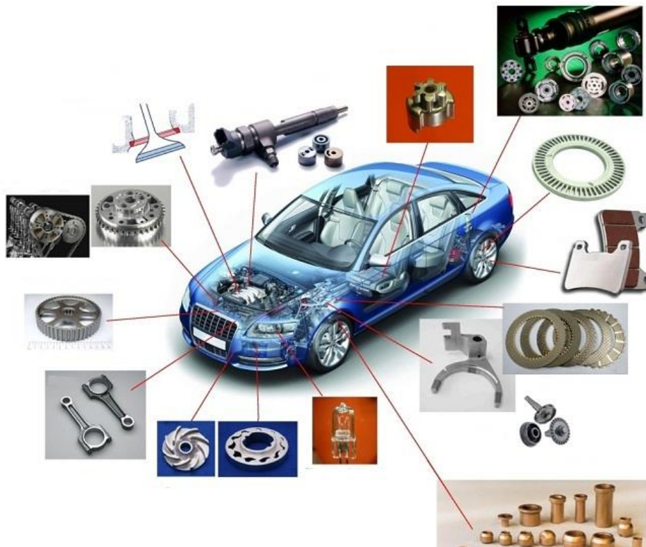
Obr. 8.2 Aplikace výrobků práškové metalurgie v různých částech osobního automobilu [1].
