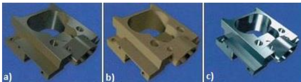
Obr. 6.28 Změna barvy vylisku po jednotlivých procesech: a) vylisek po odštípnutí, b) vylisek po odstranění pojiva, c) slinutý finální výrobek [16].
