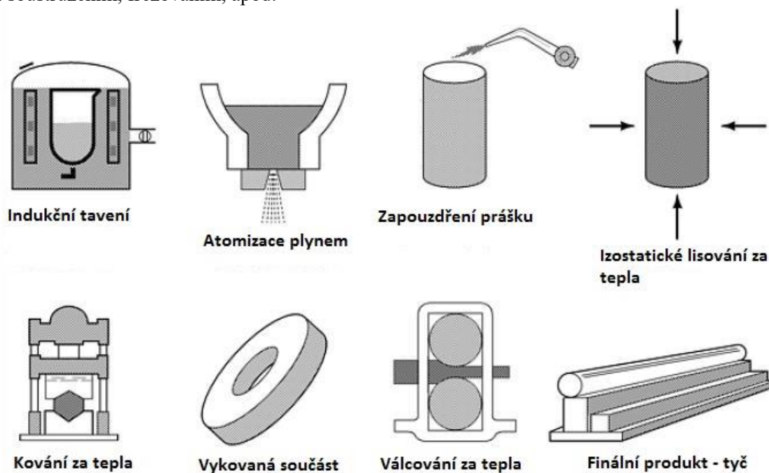
Obr. 8.12 Schematické znázornění jednotlivých kroků výroby rychlořezných ocelí [3].
