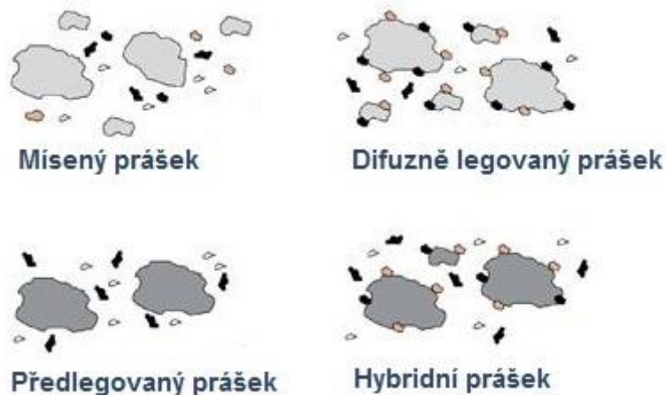
Obr. 5.1 Způsoby legování kovových prášků.
