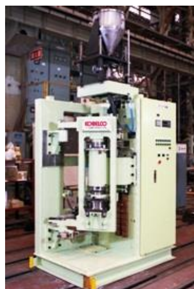
Obr. 6.17 Principiální schéma izostatického lisování za studena – metoda „dry bag“ (izostatický lis výrobce KOBE STEEL, LTD) [9].
