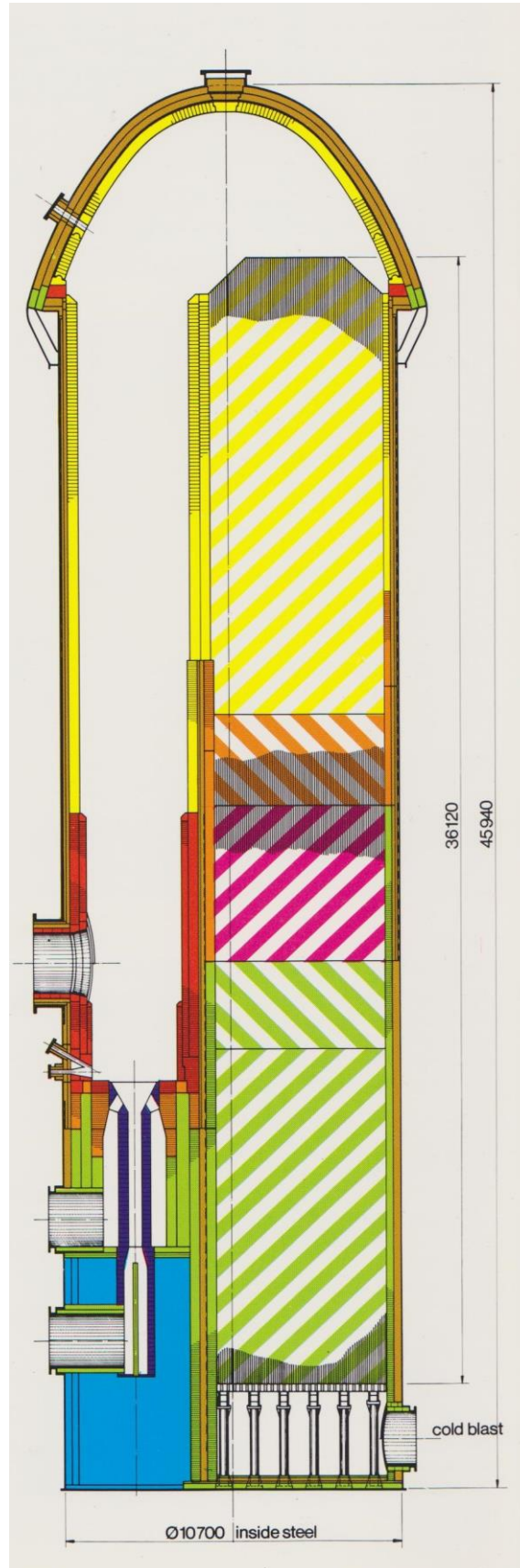
Obr. 12 Schéma ohřivače větru s vnitřní spalovací šachticí
