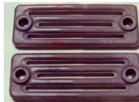
Příklady odlitků vyrobených do zmrazených forem
