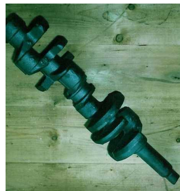
Příklady odlitků vyrobených do zmrazených forem
