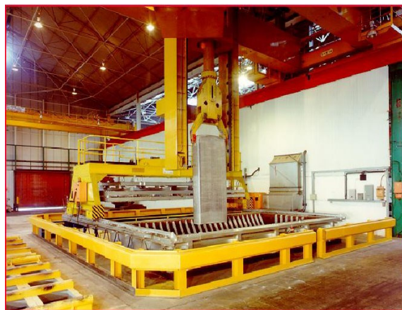
Obr. 8.23. Hlubinná pec s manipulátorem
