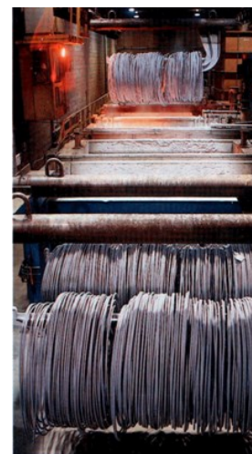
Obr. 11.3. Mořicí linka na svitky drátu
