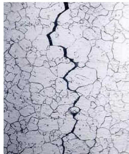
Obr. 8.21. Šíření trhliny po hranici zrna
