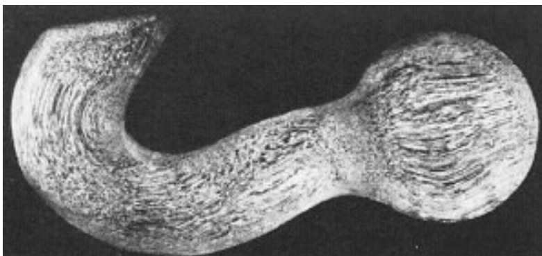
Obr. 10.3. Makrostrukturní snímek řezu výkovku háku s dobře rozpoznatelnou vláknitostí
