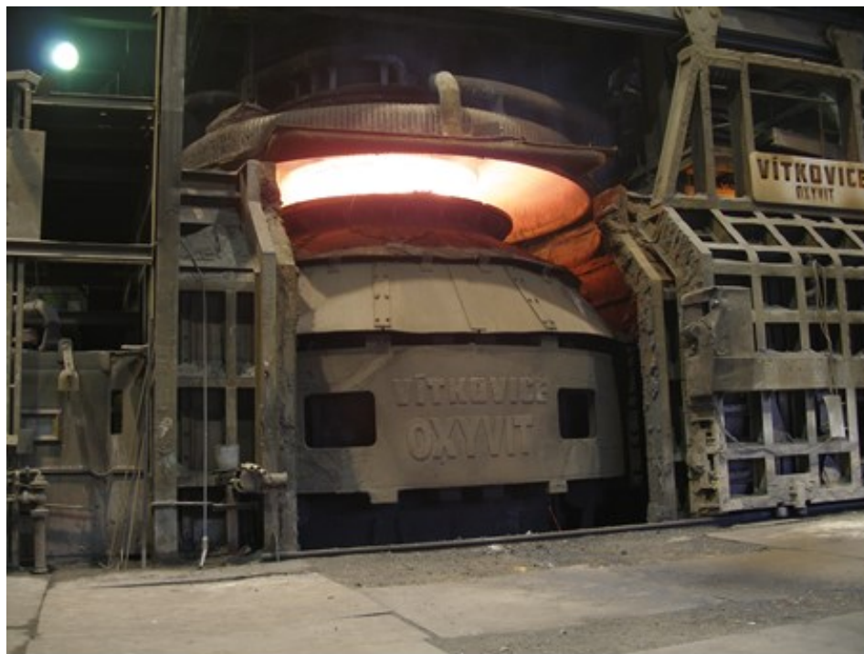
Obr. 4.1 Konvertor ve fázi ohřevu kovového odpadu
