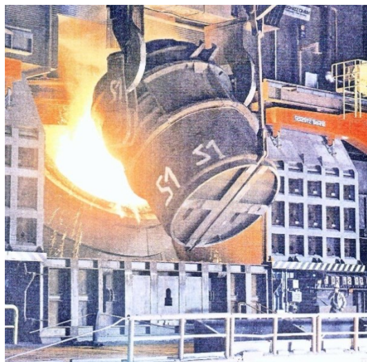
Obr. 4.2 Konvertor ve fázi nalévání surového železa
