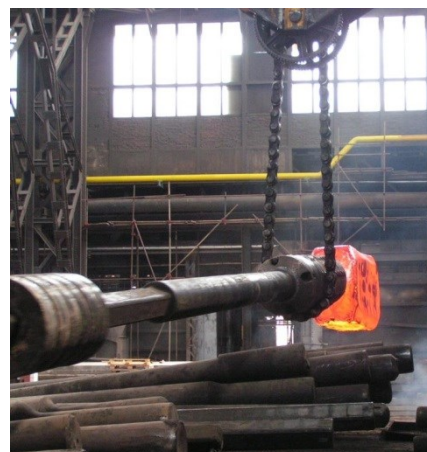
Obr. 10.23. Transport výkovku do pece (Vítkovice Heavy machinery)
