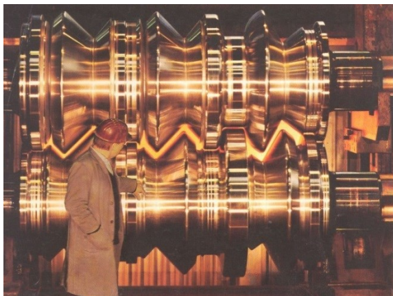
Obr. 8.4. Kalibrované válce se třemi kalibry pro výrobu Z šetovnic
