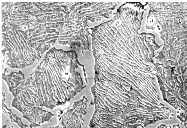
Obr.8.17. Perlit a proeutektoidní cementit na hranici původních austenitických zrn
