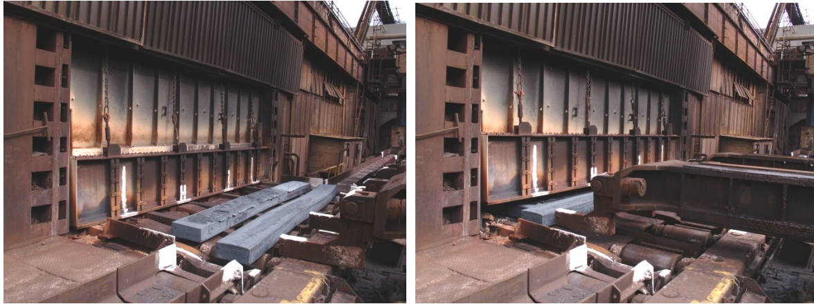
Obr. 8.25. Vstupní strana strkací pece; Válcovna těžkých profilů Evraz Vítkovice Steel; vlevo: příjezd bram po válečkovém dopravníku, vpravo natlačení bram tlačkou.
