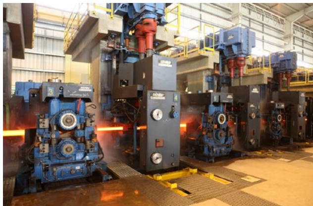
Obr. 9.17. Přípravné pořadí –HV stolice (Emirates steel)
