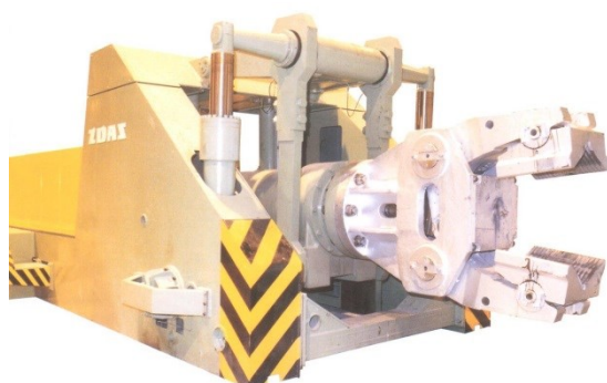
Obr. 10.25. Kovací manipulátor, Žďas, a.s.
