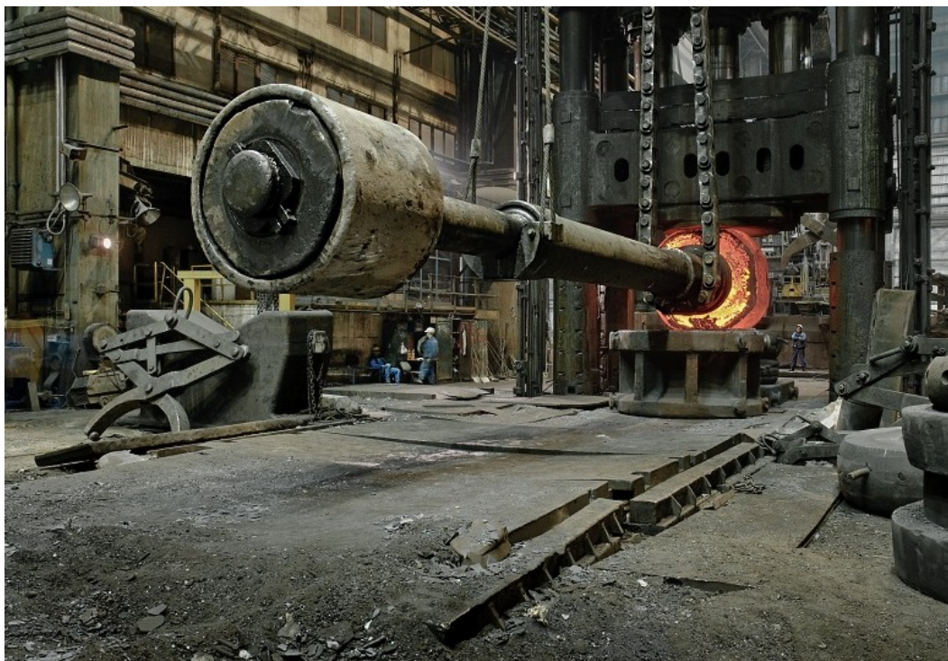
Obr. 1.61. Kovací lis CKV 105 MN, Pilsen Steel, s.r.o.
