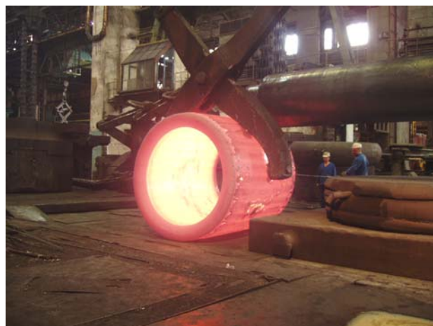
Obr. 1.64. Kování kotle – redukce tloušťky stěn, kterému předcházelo děrování viz. obr. 1.24.
