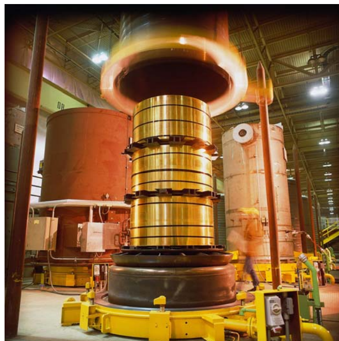
Obr. 3.10. Elektrická poklopová žhací pec, sundávání chladicího poklopu po skončení žíhání, vlevo vzadu žhací poklop.
