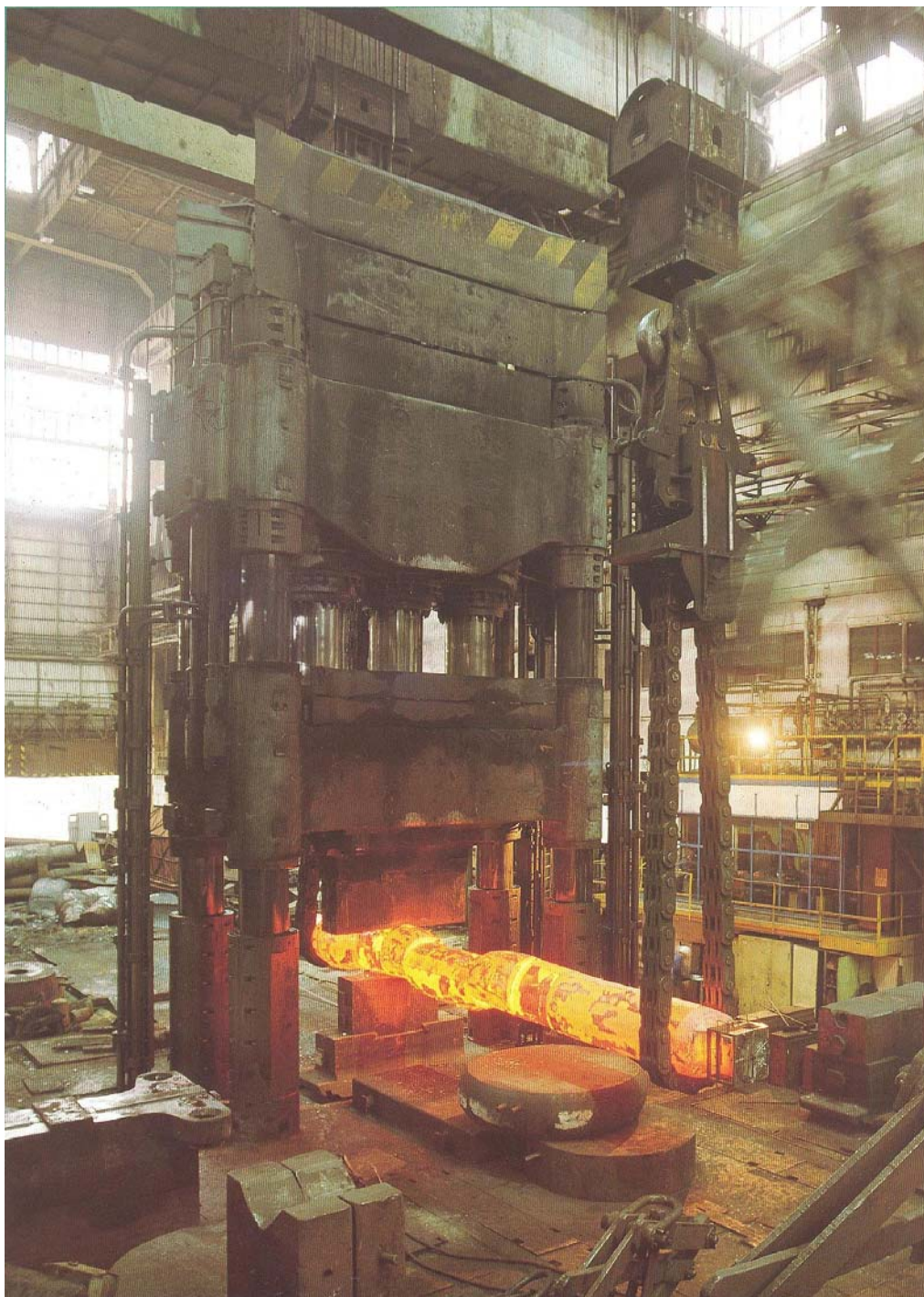
Obr. 1.62. Kovací lis CKV 105 MN, Pilsen Steel, s.r.o., kování klikové hřídele pro čtyřdobý motor
