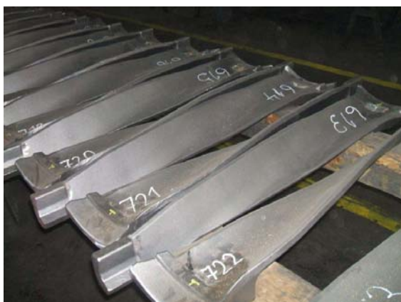
Obr. 1.65. Velké zápusťkové výkovky CPF vlevo: turbínové lopatky, vpravo: kliková hřídel
