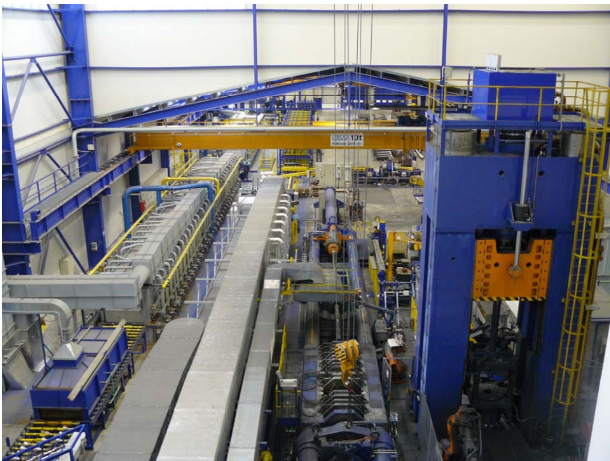
Obr. 2.5. Výroba ocelových lahví protlačováním
