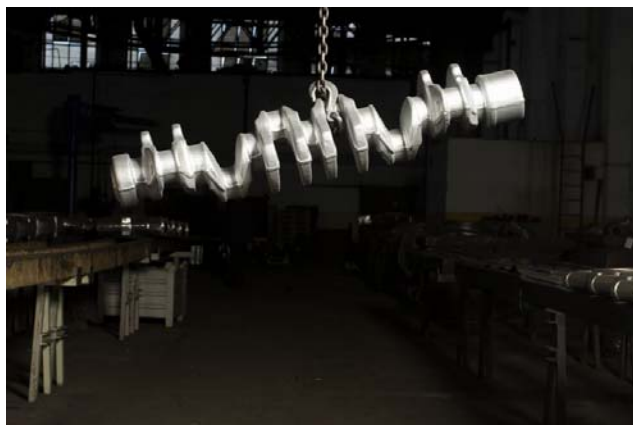
Obr. 1.65. Velké zápusťkové výkovky CPF vlevo: turbínové lopatky, vpravo: kliková hřídel
