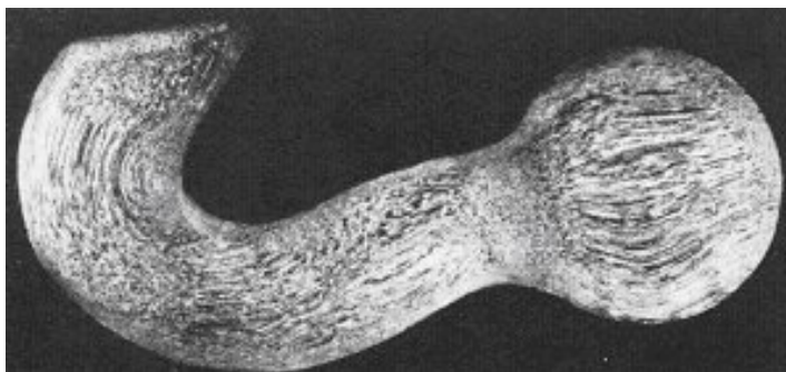
Obr. 1.7. Makrostrukturní snímek řezu výkovku háku s dobře rozpoznatelnou vláknitostí
