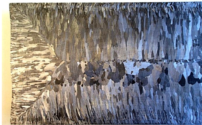
Obr. 4.4 Makrostruktura plynule lité bramy tl. 150 mm (transformátorová ocel se 3 % Si)
