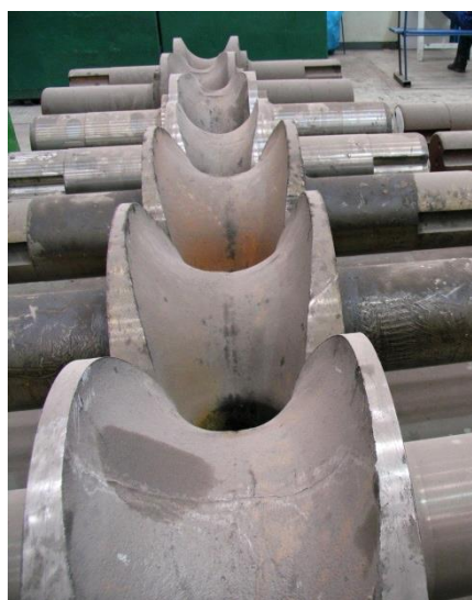
Obr. 14. 11 Poutnická stolice – válce a proces prodlužování
