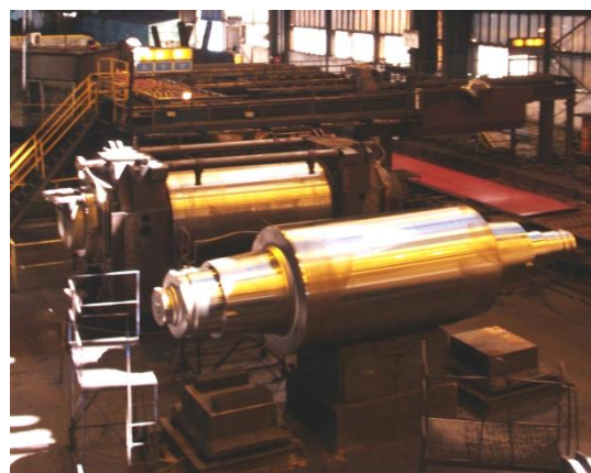
Obr. 5.7 Opěrné válce, vepředu odstojený válec, vzadu válec s ložisky a chladicími tryskami
