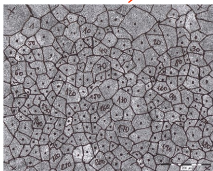
Obr. 3.2. nahoře)- vliv teploty austenitizace na velikost austenitického zrna, dole) – mikrostruktury odpovídající jednotlivým teplotám
