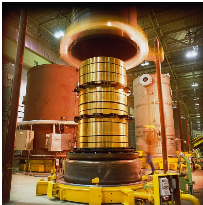
Obr. 2.39. Elektrická pokloповá žihací pec, sundávání chladícího pokloпов po skončení žíhání, vlevo vzadu žihací pokloпов.
