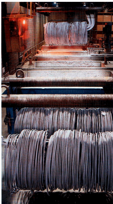
Obr. 1.10. Pohled na linku pro moření svitků – operace vápnění.
