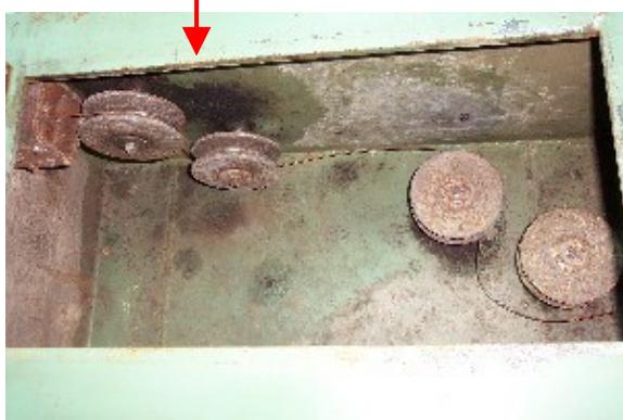
Obr. 1.17. Zařízení pro odokujování ohýbáním a kartáčováním
