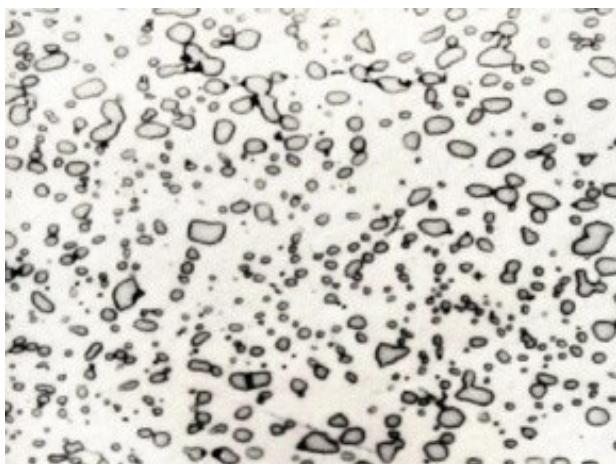
Obr. 2.35. Sfeoridizovaný cementit ve feritické matici
