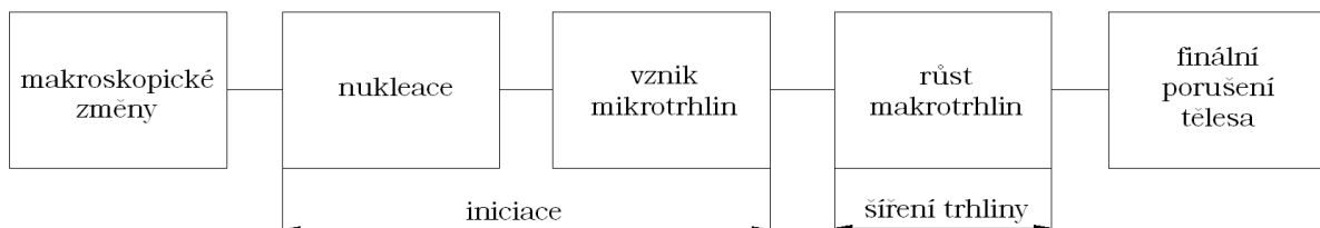
Obr. 6.2 Časová posloupnost jednotlivých stádií únavového procesu v tělese bez technologických vad.
