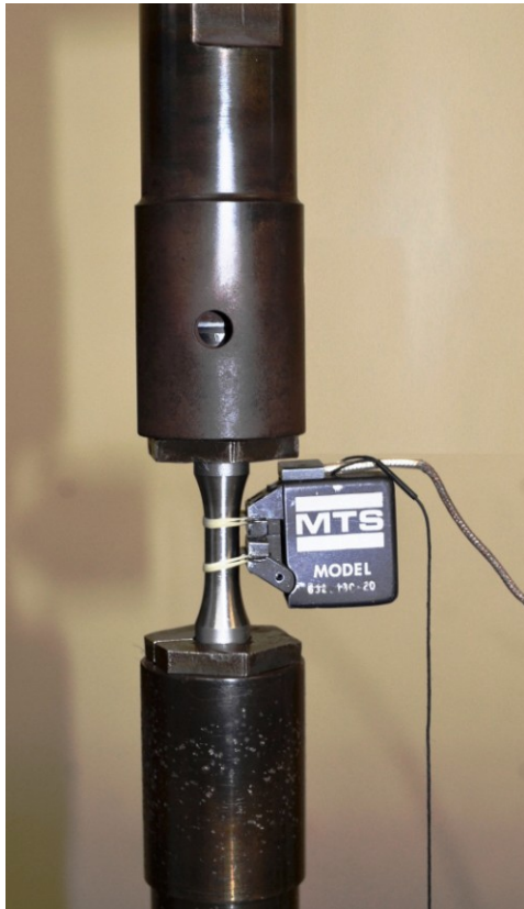
Obr. 6.15 Hladké válcové těleso se snímačem podélné deformace
