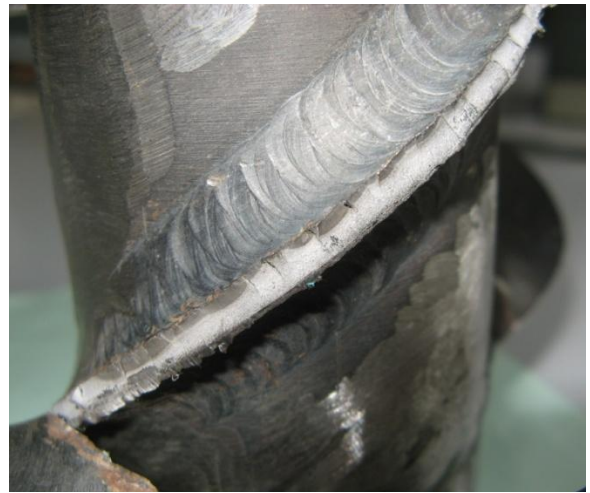
Obr. 1.3 Lopatka spojená s hřídelí swarem byla. provozována poměrně krátkou dobu v potrubí čerpací soustavy do vzniku porušení (trhlina a lomu) u svarového spoje
