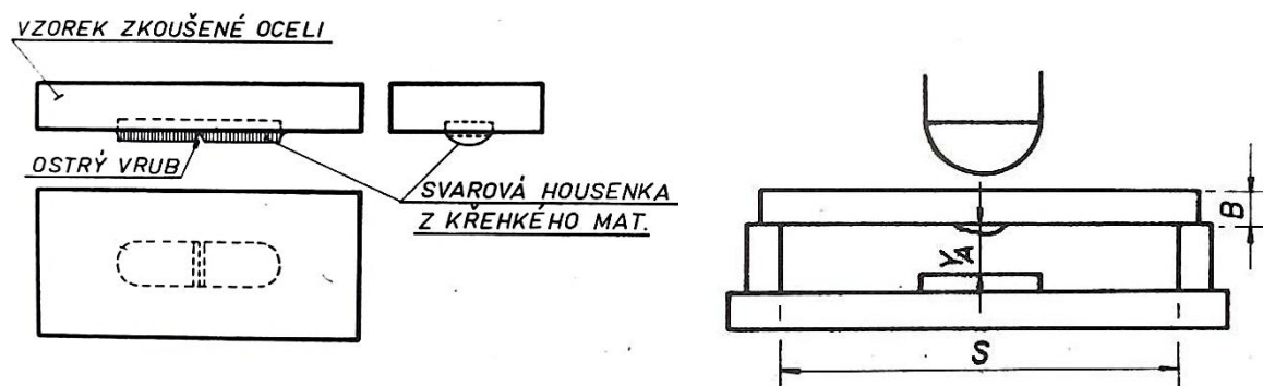
Obr. 7.3 Schéma zkoušky teploty nulové houževnatosti NDT
