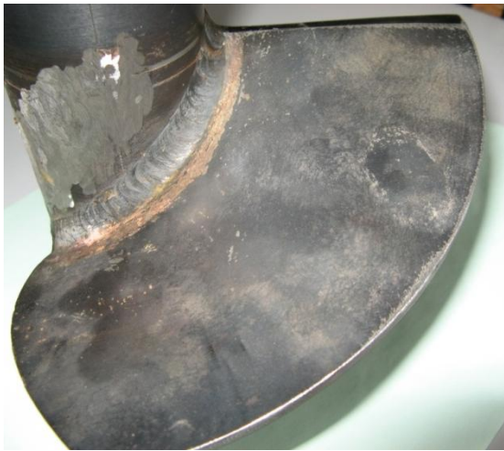
Obr. 1.3 Lopatka spojená s hřídelí swarem byla. provozována poměrně krátkou dobu v potrubí čerpací soustavy do vzniku porušení (trhlina a lomu) u svarového spoje
