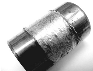
Obr. 31: Princip adhezivního opotřebení a fotodokumentace adhezivního opotřebení pístního čepu
