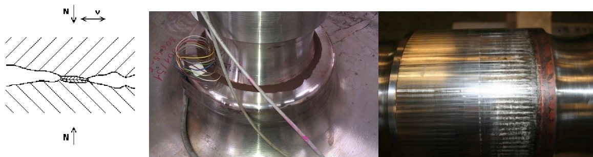
Obr. 37: Typický příklad vibračního opotřebení s výstupem oxidických částic na povrch součásti.
