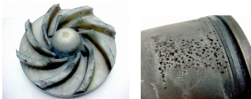
Obr. 36: Příklady kavitačního opotřebení lopatky čerpadla a válce spalovacího motoru.
