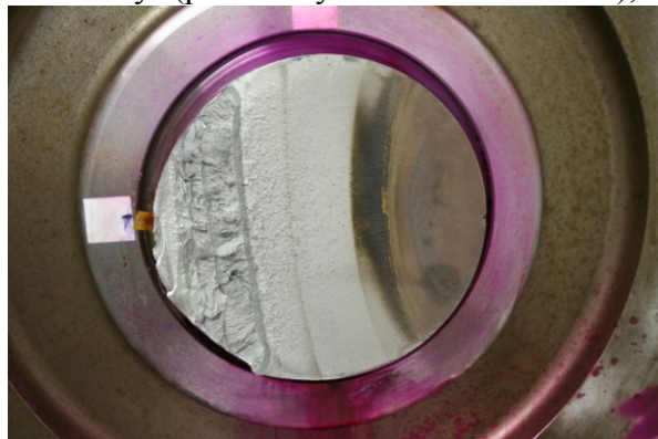
Obr. 26: Únavový lom železniční nápravy při zkoušce rychlosti šíření trhliny.
