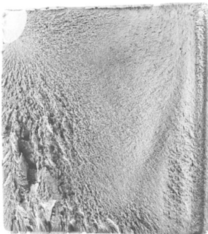
Obr. 6.3 Vějíř radiálních značek na lomové ploše ukazuje na místo, kde došlo k iniciaci porušení. Tento vějíř vzniká za podmínek rychlého šíření trhliny.
