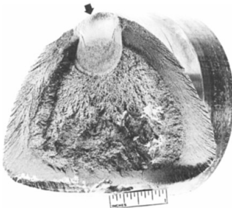
Obr. 6.6 Únavový lom povrchově kalené hřídele z uhlíkové oceli, šipka = oblast iniciace
