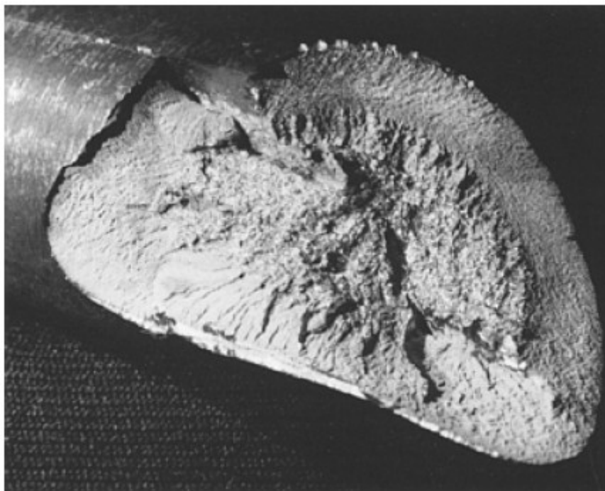
Obr. 6.5 Únavový lom, iniciace únavové trhliny v povrchové zpevněné vrstvě
