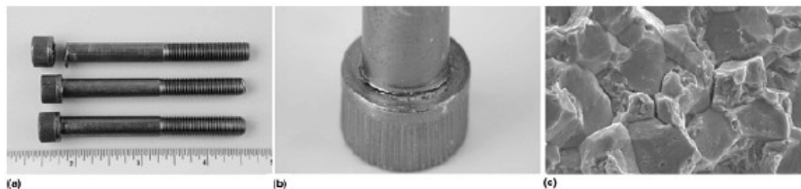
Obr. 6.2 Zbrzděné lomy pod hlavou šroubů, a) porušení šroubů zbrzděnými lomy, b) poškození šroubu pod hlavou, c) převážně intergranulární lom s úzkými tvárnými hřebeny.
