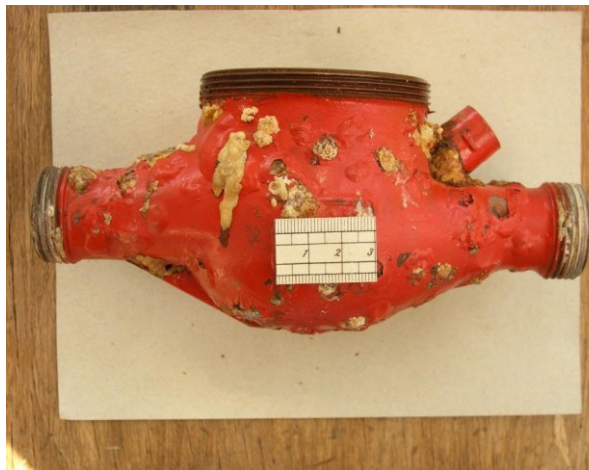
Obr. 7.1 Vodoměr s průsaky
