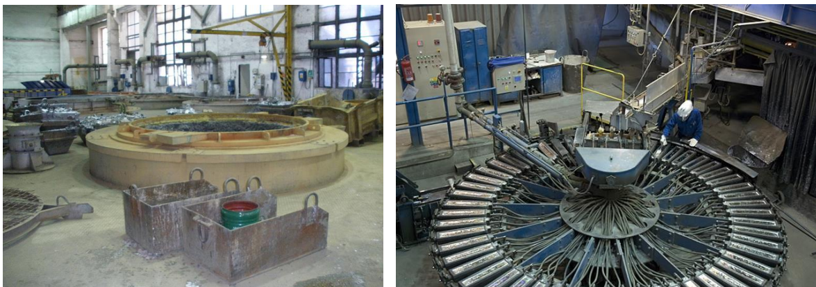
Obr. 5.12 Rafinace a odlévání čistého olova
