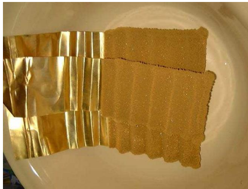
Obr. 8.2 Elektrolytické stříbro a zlato
