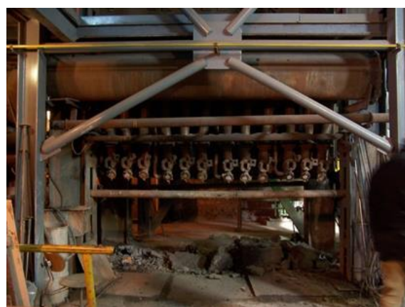
Obr. 4.10 Pohled do šachtové pece a z boku na chlazení a přívod vzduchu
