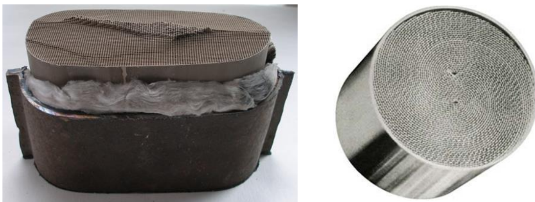
Obr. 8.4 Autokatalyzátory: monolitický, s kovovým nosičem stočený do písmene "S"
