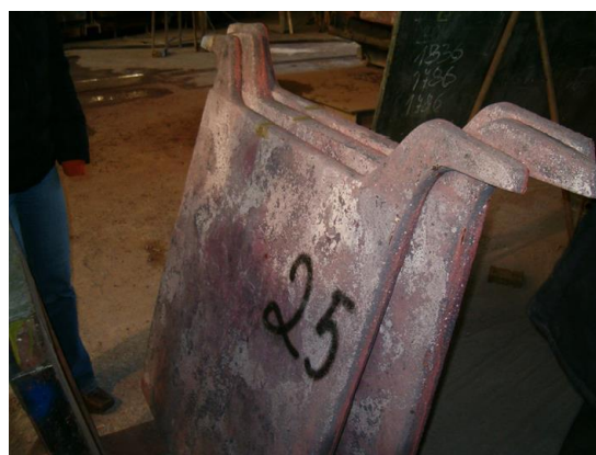
Obr. 4.13 Odlévání anod, anoda ze surové mědi - odlitek (elektroda určená k rafinaci)
