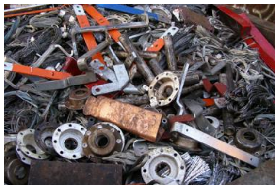
Obr. 4.6 Cu odpad pocínovaný
