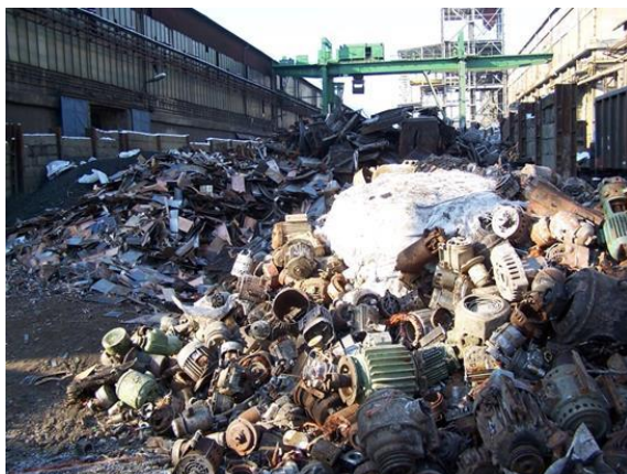
Obr. 4.8 Skládka odpadů mědi, vrstvení vsázkového materiálu před vsazením do šachtové pece
