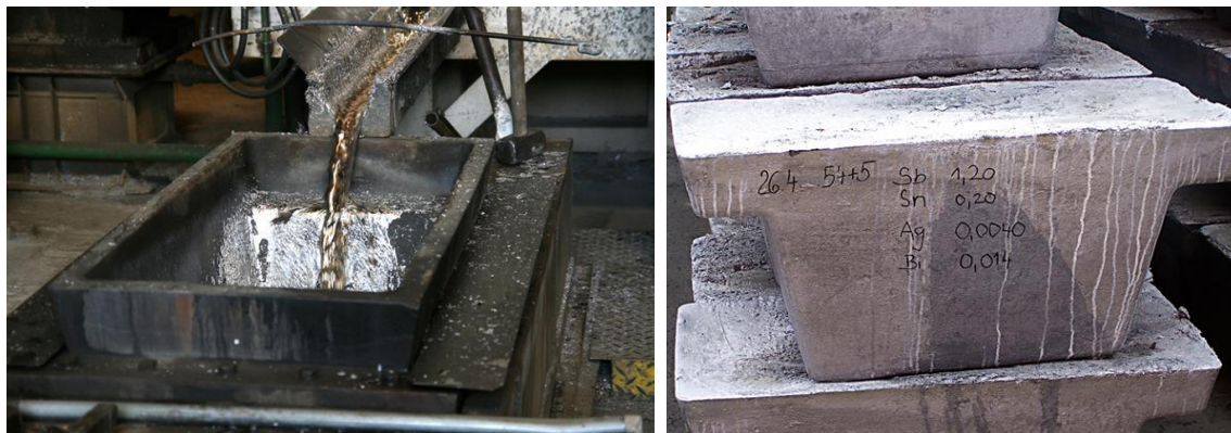
Obr. 5.10 Odlévání tekutého olova
