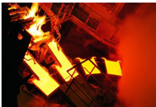
Obr. 4.13 Odlévání anod, anoda ze surové mědi - odlitek (elektroda určená k rafinaci)
