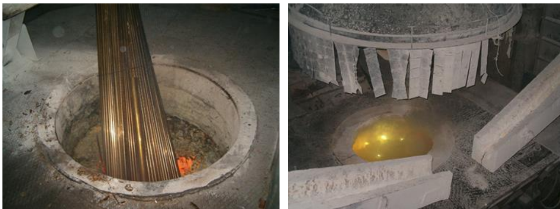
Obr. 4.7 Tavení mosazi v indukční peci s odsáváním
