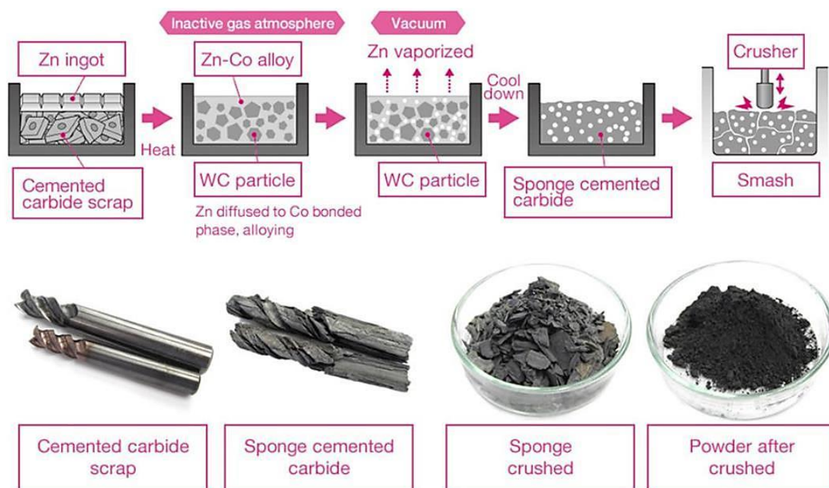
Obr. 13.3 Zn-proces zpracování odpadních slinutých karbidů
