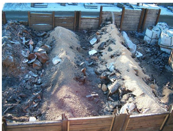
Obr. 4.8 Skládka odpadů mědi, vrstvení vsázkového materiálu před vsazením do šachtové pece
