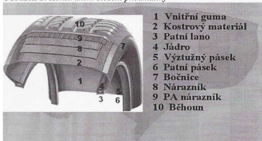
Obrázek 1: Konstrukční složení pneumatiky
