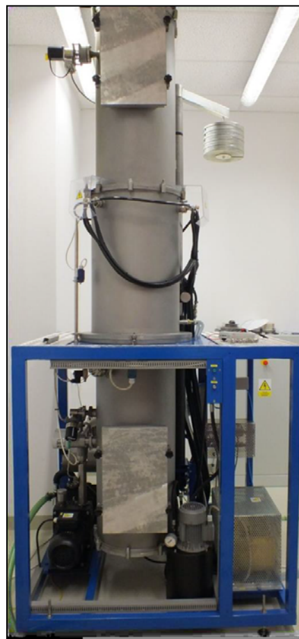
Obr. 10.1 Celkový pohled na vysokoteplotní vakuovou pec pro žhání vzorků do teplot 2200 °C
