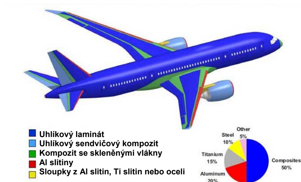
Obr.3.3. Koncepce rozložení materiálů v Boeingu 787 [2]
